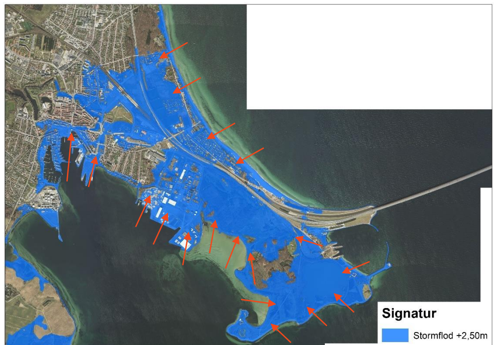
Figur 2-6 Visning af den hydrauliske forbindelse til lavtliggende områder ved stormflod i kote 2,50m.
