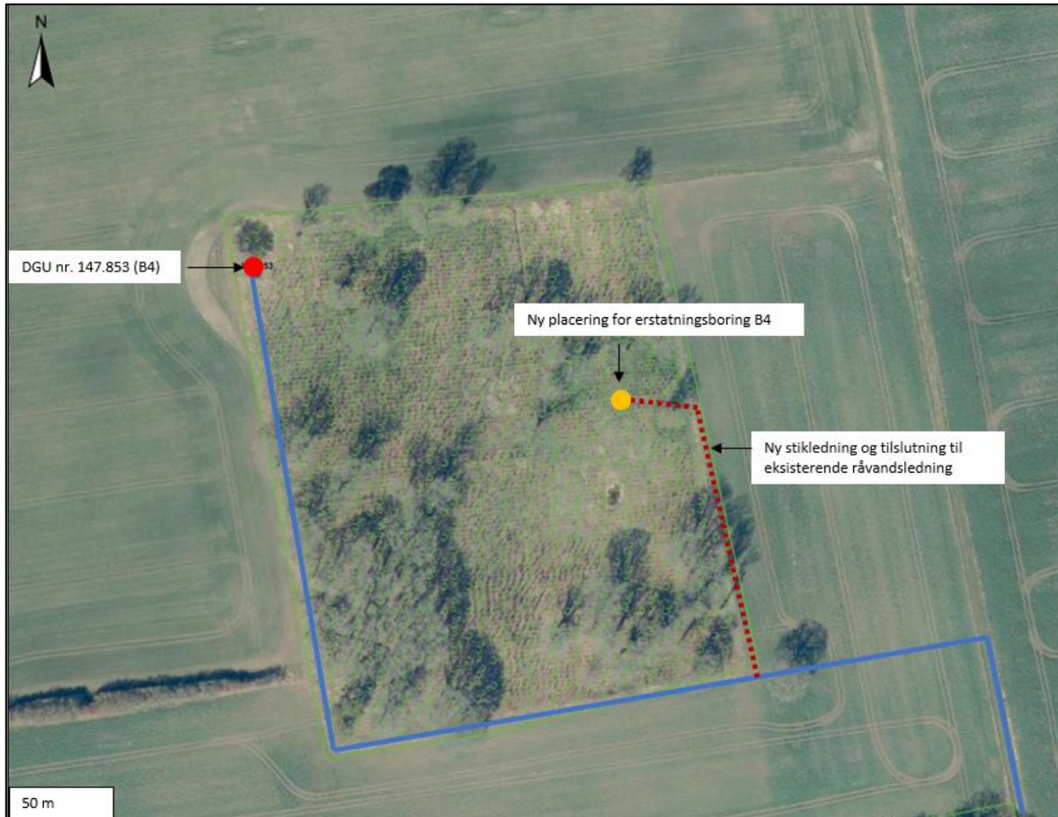
Figur 2 Placering af eksisterende boring DGU nr. 147.853, som skal erstattes af B4. Med blåt angives den eksisterende råvandsledning og med rødt den nye stikledning.
